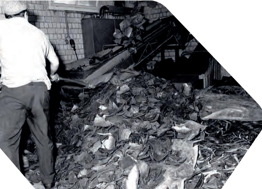
Gummizerkleinerung bei der GEZOLAN AG (1972)
